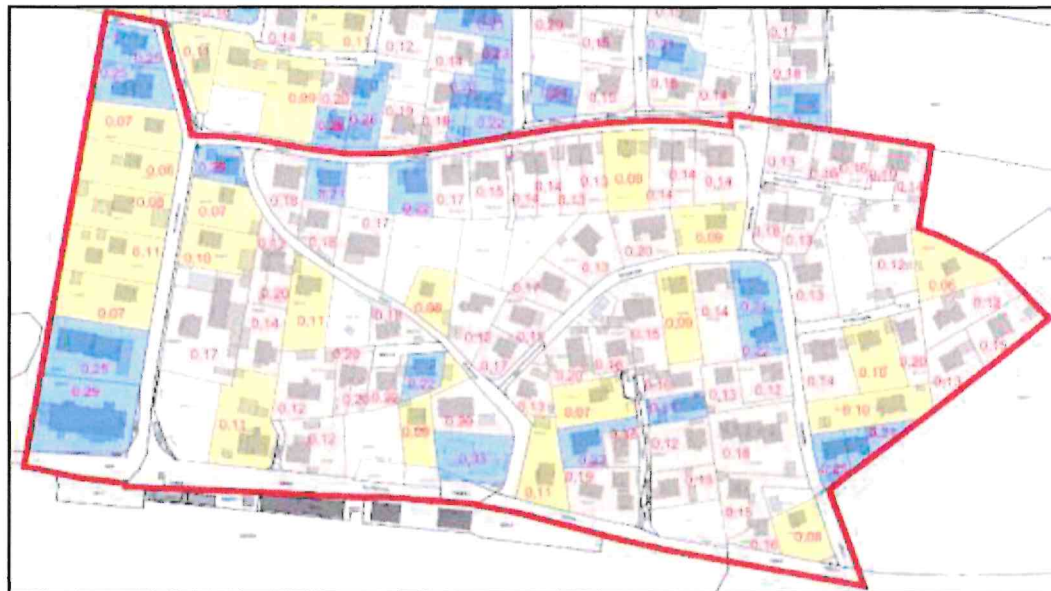
Abb. 8 Überschlägige Analyse der Baudichte der Hauptgebäude im Plangebiet, ohne Maßstab; Quelle DFK: Bayerische Vermessungsverwaltung; Stand DFK: 2020
